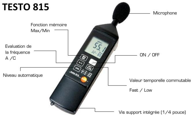
Le **Testo 815** est un sonomètre qui permet de mesurer la pression acoustique et le bruit.
