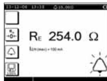
En fonction de la résistance de terre mesurée, indication du courant maximal admissible pour le disjoncteur différentiel d'entrée de l'installation
