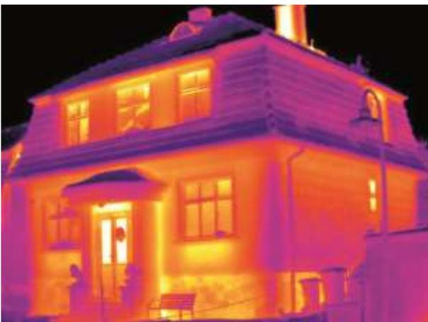
Indiquant instantanément les contrastes thermiques, même les plus faibles, certaines caméras infrarouges aident à repérer différents types de défauts, sans contact, à distance et de manière non destructive. Cela permet d'assurer l'intégrité des systèmes structurels et environnementaux pour l'inspection des bâtiments et la vérification des éventuelles réparations.
