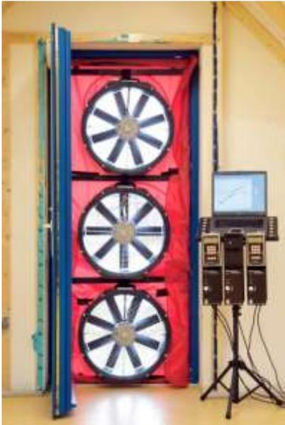
L'infiltrométrie est une des douze techniques clé pour améliorer l'efficacité énergétique d'un bâtiment. Test instrumenté, il permet de mesurer les flux d'air s'infiltrant dans un bâtiment et de vérifier son étanchéité à l'air. La mesure de perméabilité à l'air ou test de la porte soufflante est normée depuis 2001 par la norme NF EN 13829 et complétée en France depuis 2010 par le guide d'application GA P50-784.
