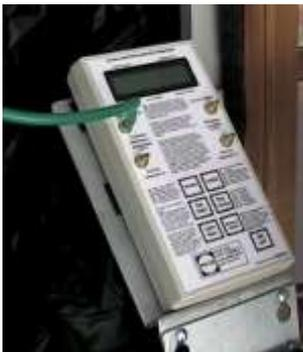
Un double-manomètre différentiel pour mesurer d'une part le débit d'air dans le ventilateur et d'autre part la différence de pression entre l'intérieur et l'extérieur de l'enveloppe testée.
