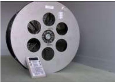
Un ventilateur étalonné et muni des capteurs de pression: ce ventilateur est étanche (le flux d'air ne passe que par lui et ne permet pas les sorties d'air parasites). Les capteurs de pression mesurent la pression de l'air qui passe dans le ventilateur et l'étalonnage permet de mesurer le débit d'air de façon précise.
