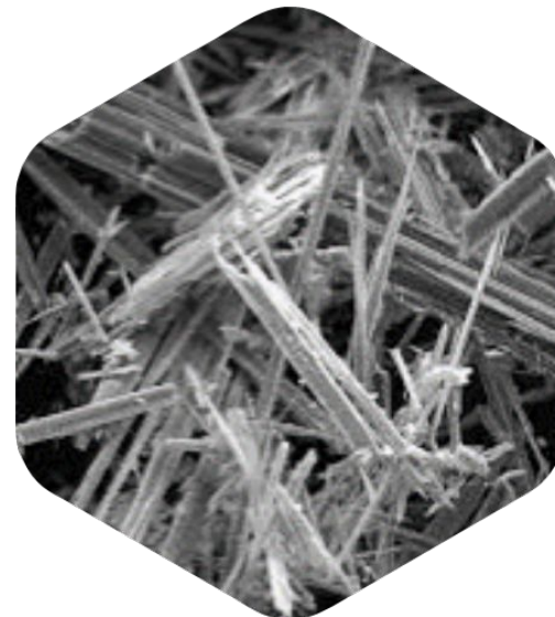
Des fibres d'amiante observées au microscope
