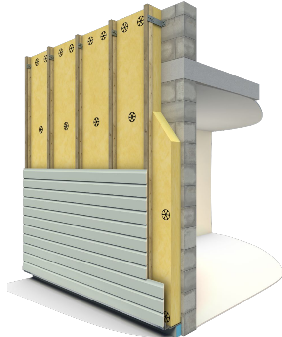
Façade ventilée Isolation sous bardage
