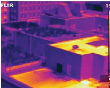
43°C d'écart entre le toit végétalisé et le toit bitumineux
